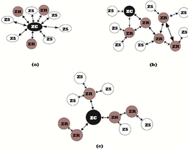
Fig. 1 .ZigBee topologies a) star b) mesh c) tree
